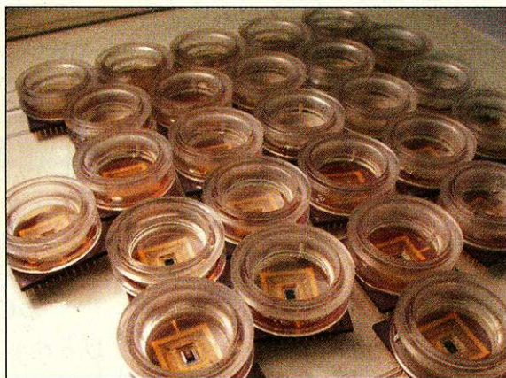
Mit 16.384 einzelnen Sensoren auf nur einem Quadratmillimeter und hochempfindlichen elektronischen Schaltungen werden die elektrischen Signale der Nervenzellen aufgenommen.
